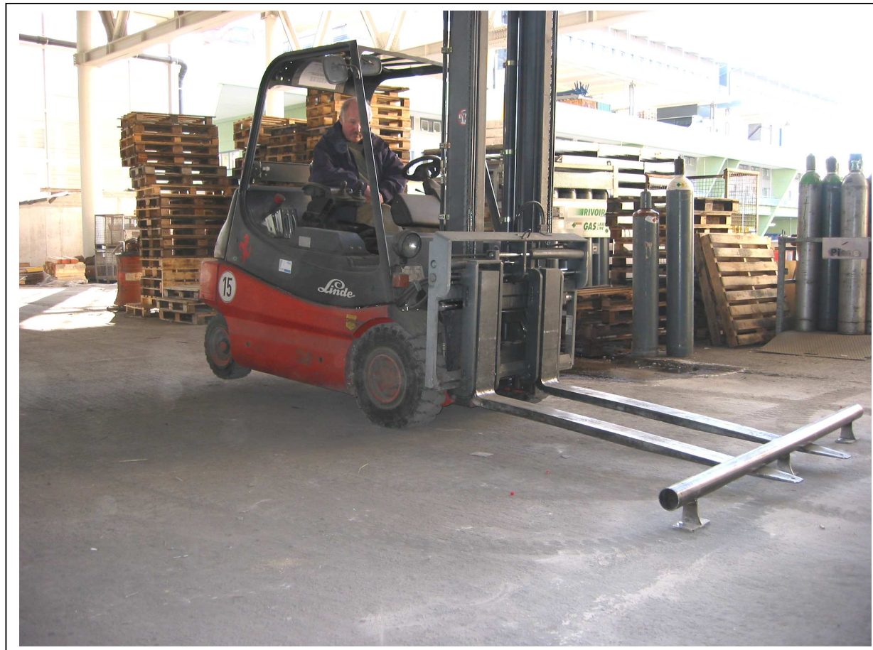
Crash-test von Art. SL 76.200 – Gabelstapler Gewicht 5000 kg
